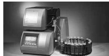
Le viscosimètre Lovis 2000 M détermine la viscosité dynamique, cinématique, relative et intrinsèque des liquides
